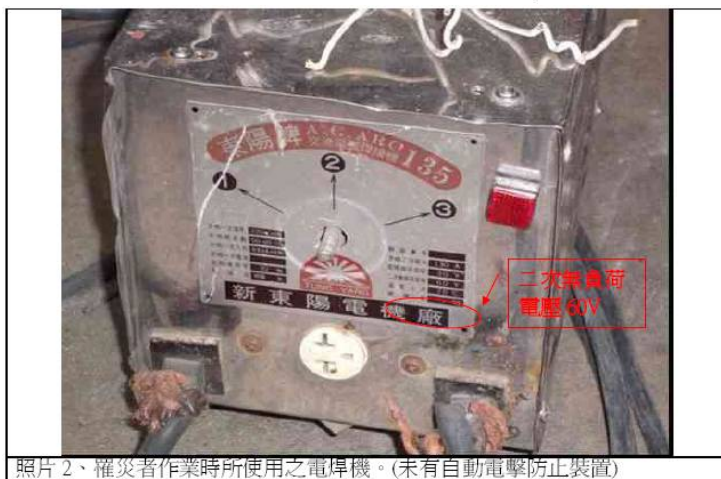
照片 2、罹災者作業時所使用之電焊機。(未有自動電擊防止裝置)
