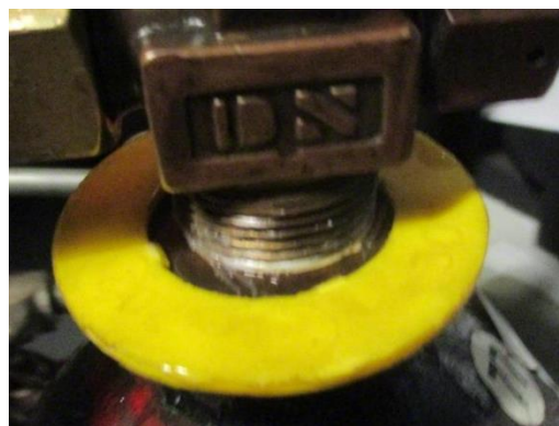
氧氣鋼瓶水壓測試環 5 年有效
