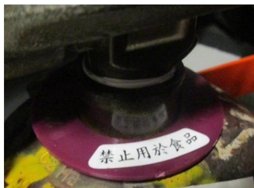
乙炔鋼瓶水壓測試環 5 年有效
